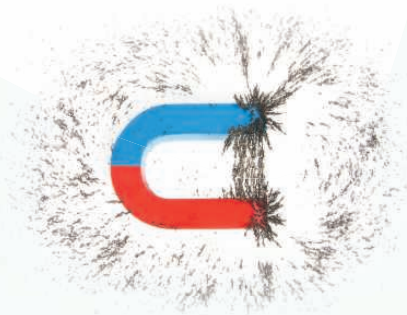
Так выглядит магнитное поле дугообразного магнита
