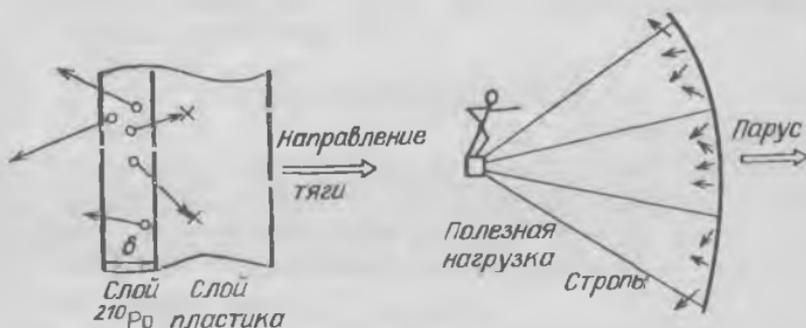
Рис. 38. Схема радиоизотопного паруса
