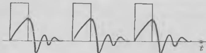
Рис. 27. Прямоугольные импульсы имитируют переподические возмущения крыла; показан «отклик» на эти возмущения, успевающий затухнуть между двумя последовательными импульсами
