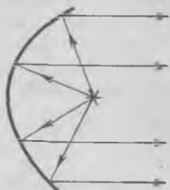
Рис. 39. Схема фотонного двигателя
