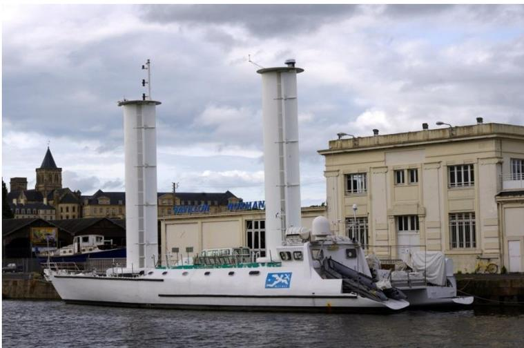
*Турбопарусник Кусто – На 2011 год «Алкиона» является единственным в мире судном с турбопарусом системы Кусто. Смерть великого океанографа в 1997 году поставила крест на постройке второго подобного корабля, «Калипсо II», а другие кораблестроители опасаются непривычной конструкции...*
