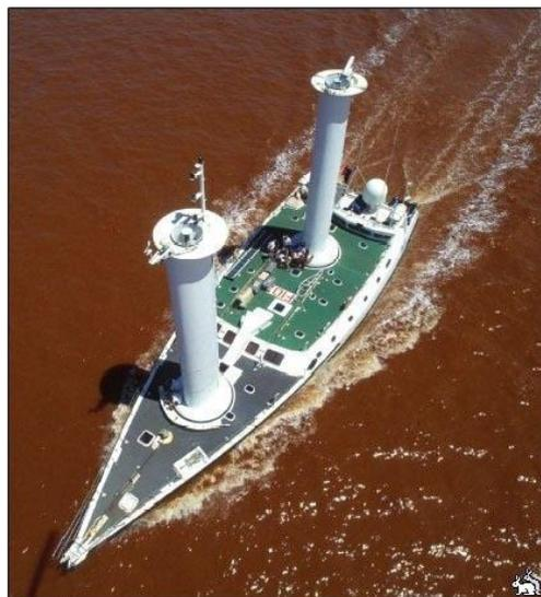
*Турбопарус представляет собой полый цилиндр, снабженный специальным насосом. Насос создает разрежение с одной стороны турбопаруса, закачивая воздух внутрь паруса, наружный воздух начинает течь вокруг турбопаруса с разной скоростью и корабль начинает*
