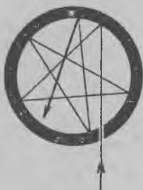
Рис. 2.3. Схема устройства абсолютно черного тела и ход луча в нем.
