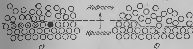
Рис. 5.5. Схема границы жидкость—кристалл: а — атомно гладкая граница; б — атомно шероховатая.
