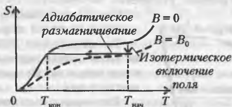
Рис. 28. Адиабатическое размагничивание. Энтропия как функция температуры без поля ( B = 0 ) и в поле ( B = B_0 )
