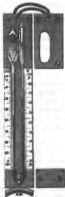
Рис. 5. Термометр для измерения температуры глубин моря Миллер-Каселла
