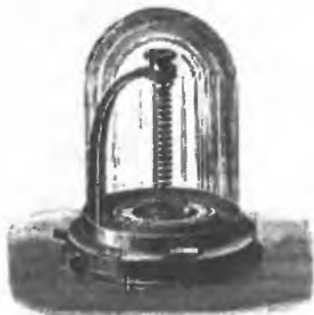
Рис. 2. Металлический термометр Брегета
