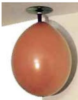
Для второго опыта ширина трубки должна быть не меньше сантиметра. Приставим диск с надутым шариком к ровному потолку и вновь дадим выход воздуху. Удивительно, но факт: теперь судно зависнет под потолком, и поток воздуха между диском и поверхностью потолка будет действовать на диск, как присоска.
