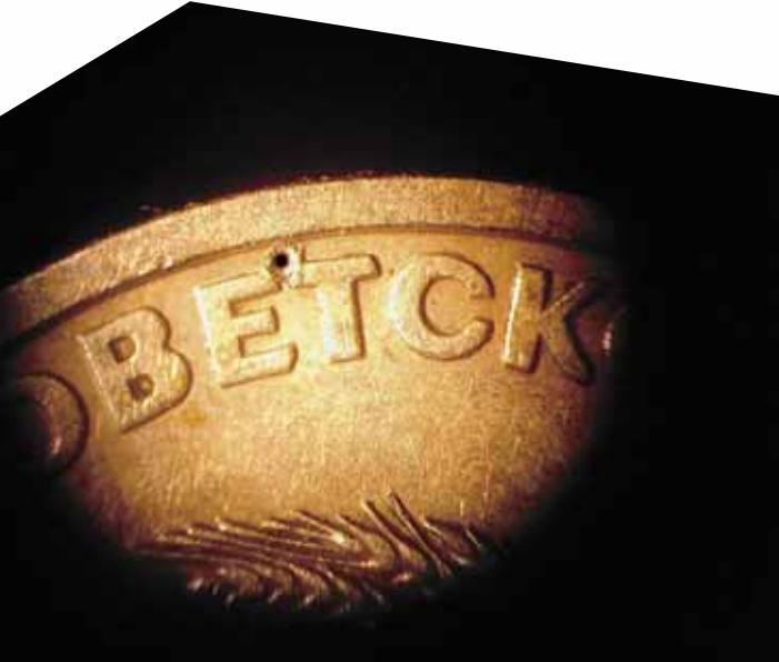
Собранный студентами физфака прямо в общежитии самодельный лазер за один импульс пробивал полтинник, за два – металлический рубль
