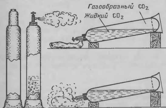
Рис. 103. Слева: жидкая углекислота в закрытом толстостенном баллоне; над ней—ее пары. Правее: когда кран открыт, жидкость вследствие понижения давления вскипает. Вверху справа: баллон наклонен, чтобы вылить углекислоту в мешок, подвязанный к крану. Внизу справа: мешок окружается конденсированными парами углекислоты, которая внутри него замерзает (в. 147).
