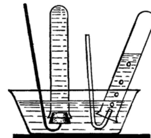
Рис. 4. Сухой способ наполнения пробирок газом
