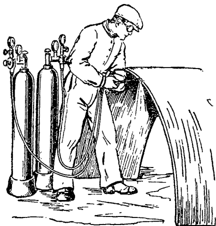
Рис. 24. Резка металла автогеном.
