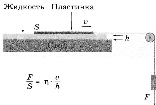
Рис. 13.1. Опыт и формула для определения вязкости  $\eta$
