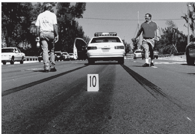
Рис.14. Длина черного следа, оставленного колесами машины после торможения, помогает оценить скорость автомобиля
