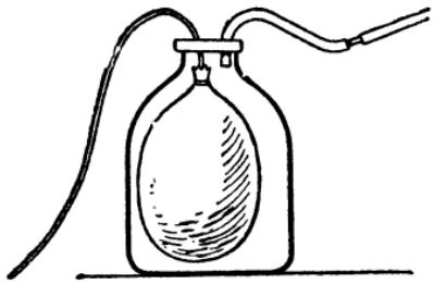
ните ее и вытрите насухо. Пузырек удалите, а вместо него с помощью нитки присоедините к тоненькой трубке оболочку воздушного шарика. Закройте плотно банку крышкой и вытяните тонкую трубку так, чтобы оболочка висела внутри под самой ее крышкой. Начните быстро работать насосом. По мере удаления воздуха из банки шарик будет раздуваться и быстро заполнит всю внутренность сосуда.
