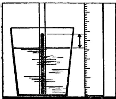
Отношение плотности масла и воды можно измерить с помощью прямой стеклянной трубки, поддерживаемой вертикально в стакане воды, как показано на рисунке.
