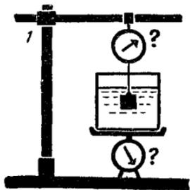
1. Стальной кубик, вес которого  $785 \text{ г}$ , подвешен к динамометру. На площадке второго динамометра стоит банка с водой. Стрелка этого динамометра показывает  $5 \text{ кг}$ . Затем опускают кубик в воду (см. рисунок). Стенок и дна банки он не касается. Что покажут оба динамометра?
