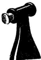
Пришлось поломать голову, чтобы уяснить себе цель неведомого конструктора бутылки и оценить его остроумие. В самом деле, расположение пробки поперек горлышка дает немало неоспоримых преимуществ. Если в эту бутылку налита минеральная вода или шипучий квас, то вовсе незачем вгонять с силой
