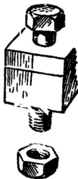
А вторая задача состоит вот в чем. Как известно, все металлические стержни при нагревании заметно удлиняются. Если мы затянем гайку при низкой температуре, то при высокой, из-за удлинения болта, крепление ослабнет. Как избежать этого?
