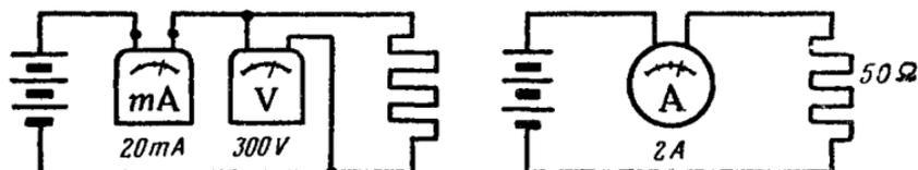
Вычислите в ваттах мощность тока  $P$  в цепи, руководствуясь показаниями приборов. По данным сопротивления и показанию амперметра вычислите количество тепла  $Q$  (в калориях), выделившееся на сопротивлении за  $1/12$  сек.  $Z$  равен численному значению разности  $P - Q$ .
