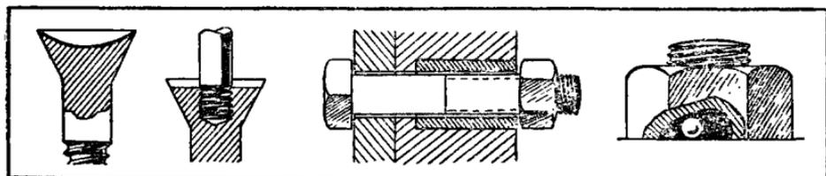
Неотвертываемая гайка имеет снизу небольшой паз, в который вложен шарик. Дно паза скошено. При вращении гайки в обратную сторону шарик заклинивается и препятствует отвертыванию гайки.
