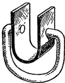
Второй способ: изогнуть ручку и основание, как показано на рисунке, а потом свинтить их и разогнуть.
