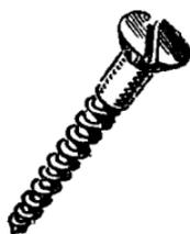
А недостатки? Возьмите, например, прорезь в головке, которая служит для установки в ней отвертки. Она обычно мелка, легко срезается при завинчивании, а если сделать ее глубже, головка становится непрочной, отвертка плохо держится в прорези. Нельзя ли усовершенствовать шуруп, чтобы устранить эти недостатки?
