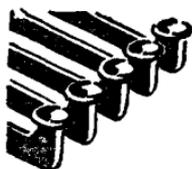
Давайте решим еще одну задачу. В разных отраслях техники встречаются машины, управляемые клавиатурой,— например, пишущие, счетные. Надо сделать механизм, который при нажатии на один клавиш блокировал бы остальные, не давая возможности нажать сразу два клавиша.
