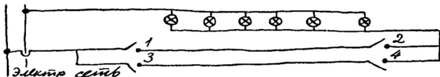
Чтобы не забыть, какие выключатели надо включать, а какие выключать, я составил табличку. Ее надо повесить и у входа и у выхода. По табличке легко разобраться в действии моей схемы, а сама она будет инструкцией для пользования выключателями.
