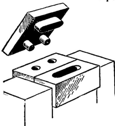
Штамп должен иметь 3 пробойника — для удлиненного отверстия и для 2 круглых, расположенных в 2 ряда. Заготовки закладываются под штамп сразу по 2, но по 2 раза каждая.
