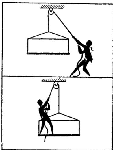
Рассмотрим схему (рисунок внизу). Здесь площадка с человеком висит на 2 нитях и общий вес распределится на обе нити поровну. Человек тянет за одну нить, и, следовательно, необходимая сила вдвое меньше, чем их общий вес. Если вес человека и площадки составляет 90 кг, то для подъема потребуется сила не 90 кг, а только 45 кг, но зато при подъеме на 3 м нужно перемотать 6 м троса, так как одновременно укорачиваются 2 нити. Проигрыш в пути еще раз подтверждает наличие выигрыша в силе.
