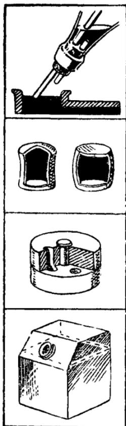
Самозапирающуюся пробку проще всего сделать пустотелой, например из полиэтилена. Верхняя ее поверхность должна быть выпуклой, а боковая — чуть вогнутой. Вставив пробку в горлышко, нажмем на нее сверху пальцем — верхняя поверхность вдавится, а боковая раздастся и закрепит пробку.
