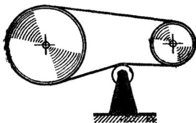
Или такая задача. В одном месте вы наметили обычную ременную передачу с натяжным роликом. Но по ходу дела выяснилось, что крепить ролик не к чему, а изменять расстояние между центрами шкивов нельзя. Как обеспечить натяжение ремня?
