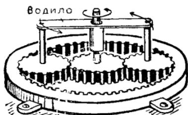
Этот рисунок схематически показывает устройство редуктора (прибора для изменения числа оборотов). Все 3 зубчатые колеса одинаковые. Сколько оборотов сделает внутренний вал, когда водило повернется вокруг центральной оси один раз?
