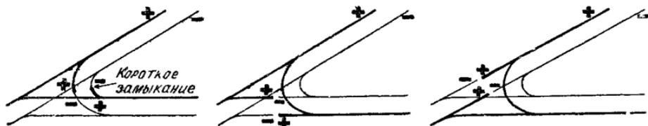
последние 2 секции рельсов этого треугольника, контактная сеть оказалась замкнутой накоротко. Выход из положения — разорвать цепь (разъединить секции рельсов) в любой из 3 сторон «запретного треугольника». Короткое замыкание будет ликвидировано, и поезд поедет.
