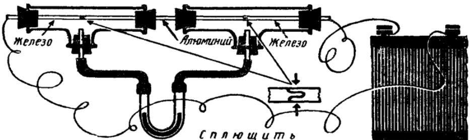
Поместим места стыков в герметично закупоренные тройники, соединенные изогнутой стеклянной трубкой.
