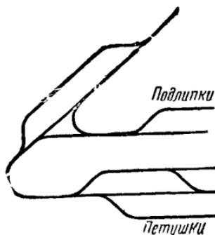
Володя соединил секции рельсов по приведенному схематическому плану, поставил на рельсы электровоз с вагончиками и, объявив, что поезд следует до станции Петушки, включил ток. Поезд не двинулся с места. Почему? Что должен сделать Володя, чтобы его поезд хоть и с опозданием, но все-таки прибыл на станцию назначения?
