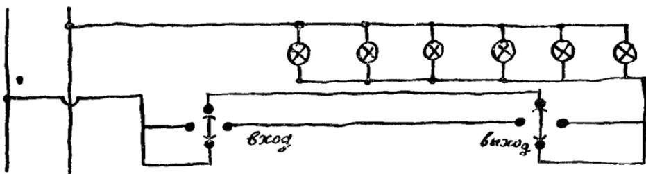
Вот эта схема. Лампочки можно включать и выключать, не раздумывая, как при входе в овощехранилище, так и при выходе из него.
