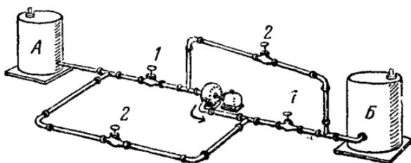
ты клапаны 1 и открыты клапаны 2, то при том же направлении движения масла на выходе из насоса оно будет перекачиваться из бака Б в бак А.
