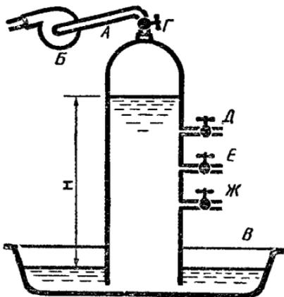
1. Через трубку *А* насосом *Б* подняли воду из таза *В* на высоту *И* и закрыли кран *Г*. Затем некто открыл сразу 3 крана: *Д*, *Е* и *Ж*. Спрашивается: из какого крана вода будет течь дольше и дальше всего?
