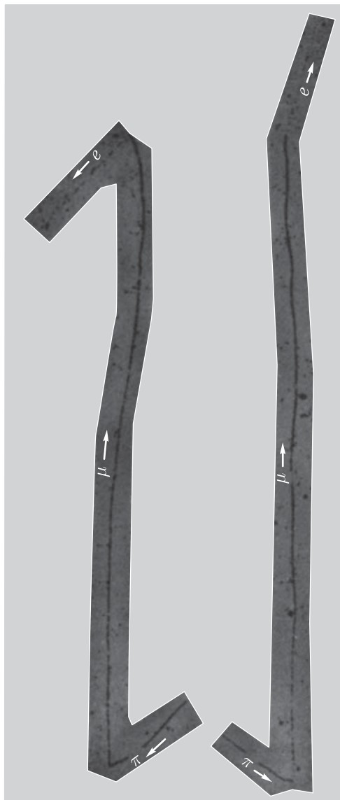
Рис. 415. Два случая распада \pi -мезона, зарегистрированные в фотоэмульсии. \pi -мезон останавливается и распадается по схеме \pi \rightarrow \mu + \nu (левая часть снимка); нейтринно следа не оставляет. Образовавшийся мюон, пройдя путь около 0,6 мм, также останавливается и распадается по схеме \mu \rightarrow e + 2\nu . Быстрые частицы слабее ионизуют и образуют менее плотные следы — ср. след электрона и начальный участок пути мюона. Заряды частиц в данном опыте определить нельзя, но скорее всего они положительные: в фотоэмульсиях \pi^+ -мезоны обычно поглощаются ядрами, не успевая распасться. Напротив, \pi^+ -мезоны ядрами отталкиваются и им после торможения остается только распасться
