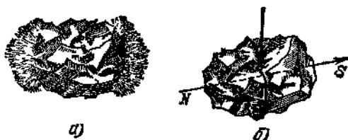
Рис. 192. Естественный магнит: а) магнитная руда притягивает к себе железные опилки; б) магнитная руда, подвешенная на нити, устанавливается определенным образом — с севера на юг ( N \rightarrow S )
