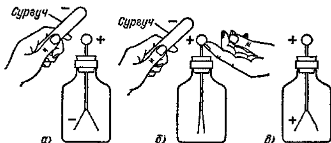
Рис. 16. Различные стадии зарядки тела через влияние: а) приближая к шарiku электроскопа отрицательно заряженный сургуч, мы вызываем на стержне электроскопа положительный заряд, а на его листках — отрицательный заряд; б) не убирая сургуча с отрицательным зарядом, прикасаемся рукой к шарiku электроскопа и отводим часть отрицательного заряда электроскопа через свое тело в землю; листки электроскопа спадают; в) убрав палец, а затем убрав сургуч, мы оставляем на электроскопе только положительный заряд, который распределяется между шариком и листками электроскопа
