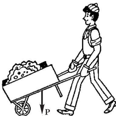
Рис. 139. Тачка как рычаг
