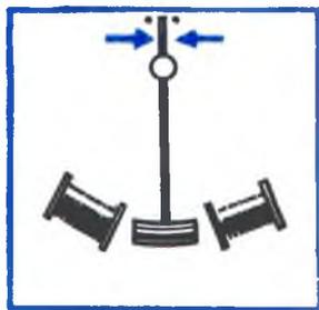
расходятся к периферии, сжимая пружины. По мере замедления вращения под действием пружины грузы сходятся. Вследствие этого уменьшается момент инерции. Благодаря этому угловая скорость волчка изменяется очень медленно. За счет энергии сжатых пружин волчок вращается очень долго.
